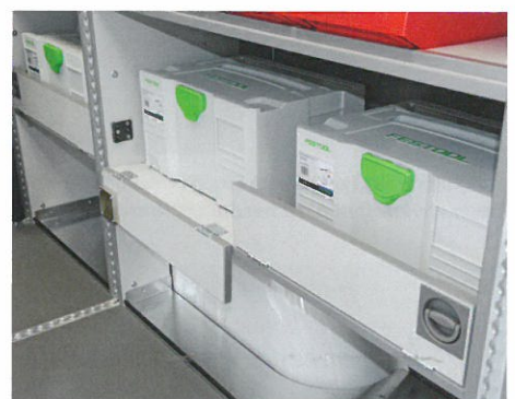
/ Unterhalb der herausnehmbaren Kleinteileboxen können die gängigen Werkzeug- und Maschinenkoffer zum Baustelleneinsatz transportiert werden.
