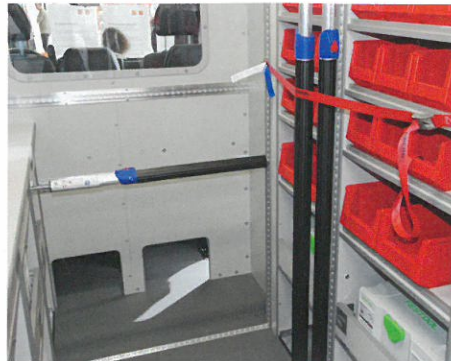
/ ... sorgen viele Befestigungspunkte für Spannstangen und Zurrgurte. Das Airline-Schienensystem ist bündig in Boden, Decke und Einrichtung montiert.
