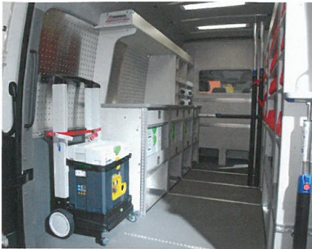
/ ... Durchlademöglichkeit für Langgut. Der beleuchtete Innenbereich ist zugleich Bankraum, Werkzeug- und Kleinteilelager. Für flexible Ladungssicherung ...
