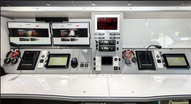
Zwei Funkarbeitsplätze, Bedienung über LARDIS, Telefonanlage und PC. Digitale Steuerung und Überwachung der Stromversorgung.
