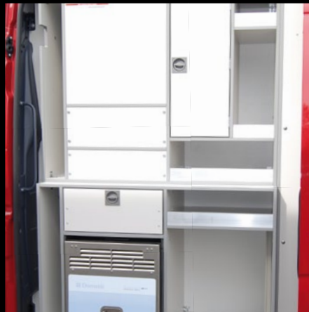
Über die Schiebetür zugängliches Regalsystem mit integriertem Notstromaggregat
