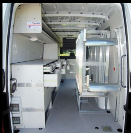
Emissions-Messfahrzeug des TÜV mit 19"-Racks für Messgeräte
