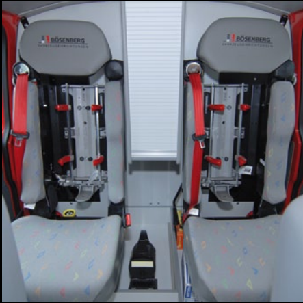
Sitze mit integrierter Halterung für Pressluftatmer
