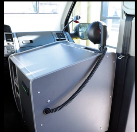
Büroblock als Ersatz für den Beifahrersitz in einem Flughafen-Vorfeldfahrzeug
