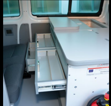
Arbeitsplatz mit großen Auszügen, Stromversorgung und Kabelablagen
