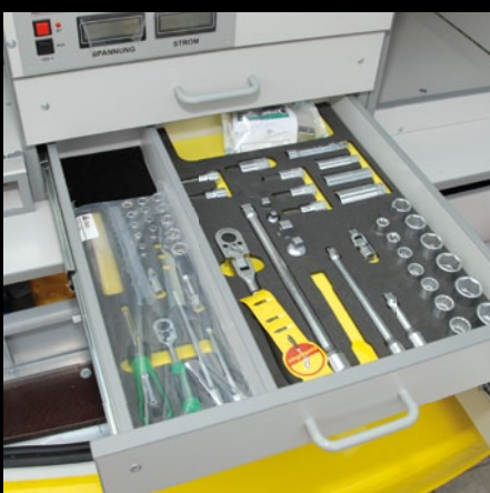
Farbcodierte Werkzeugablage für sicheren Transport
