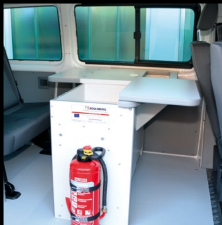
Klappbare Arbeitsplatten erweitern die Schreibflächen
