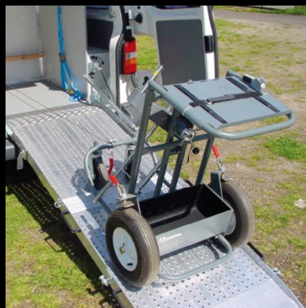
Rampe mit Winde für einen Strahlenmesswagen
