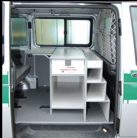
Arbeitsplatz in einem Unfallaufnahmefahrzeug
