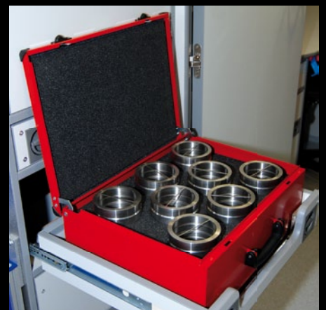
Auszug für Sonden in einem Strahlenmessfahrzeug
