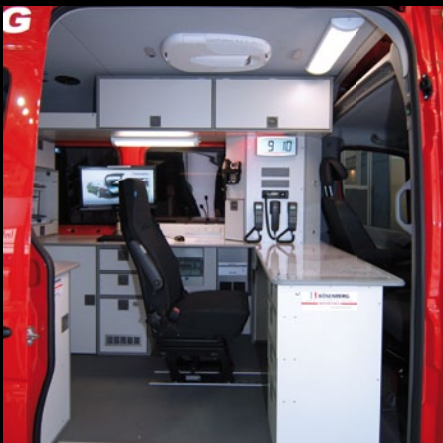
Einsatzleitfahrzeug ELW 2: Arbeitsplatz mit Einzelsitz
