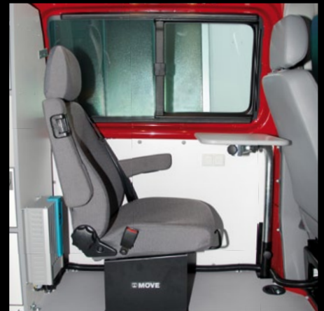
Kompakter Arbeitsplatz mit Einzelsitz, Tisch, Beleuchtung und 230 V Wechselrichter
