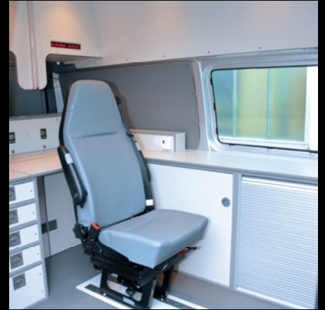
Drehsitz mit Dreipunktgurt als Fahr- und Arbeitssitz
