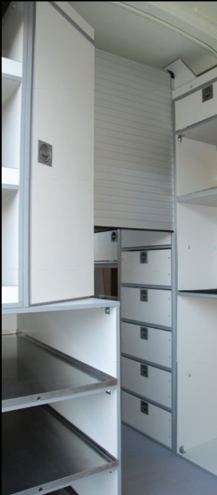
Abtrennung zwischen Büro- und Arbeitsraum über einen elektrischen Rollladen
