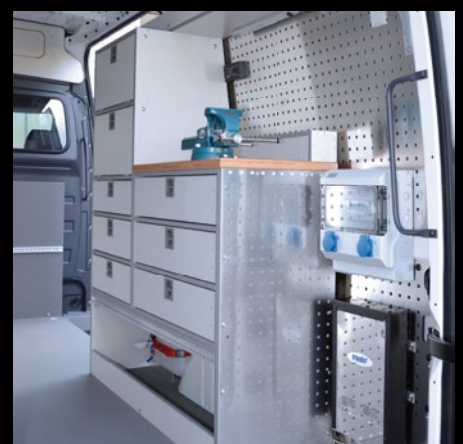
Arbeitsplatz mit Dynawatt® Stromversorgung und Arbeitsplatte mit Schraubstock
