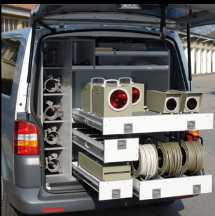
Trägersystem für eine Geschwindigkeitsmessanlage
