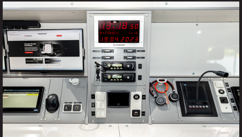
Funkturn mit GPS-Uhr, Tetra-Kartenleser, 2m Funk und Systemmonitor zur Energieüberwachung.
