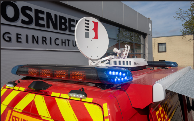
BOS-Satellitenantenne und Dachklimaanlage auf dem Dach.
