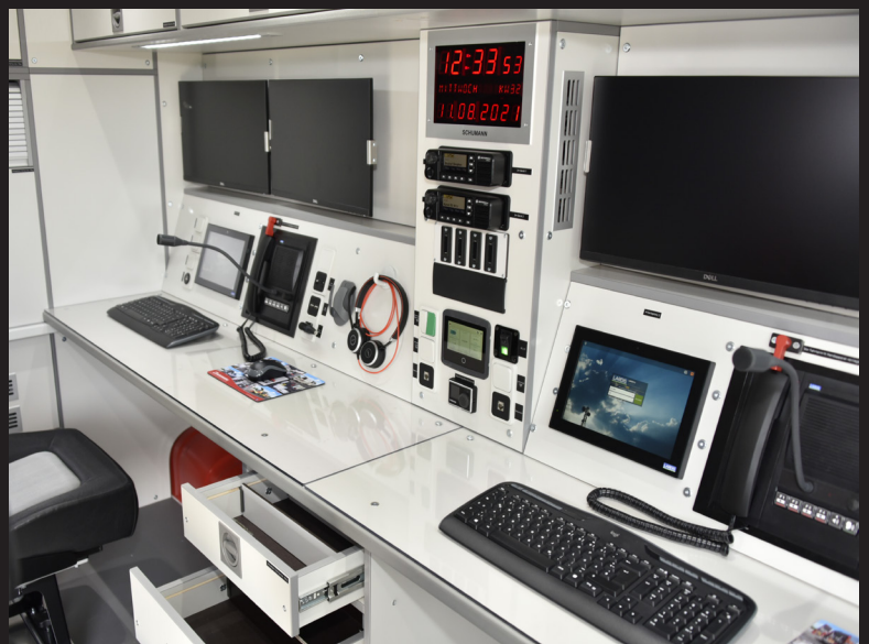
Funkturn mit GPS-Uhr, Tetra-Kartenleser, 2m Funk und Systemmonitor zur Energieüberwachung.
