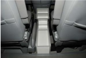
6. Zwei Löcher Ø 6,5 mm durch Mittelkonsole und Halteblech bohren und in der Konsole einsenken
