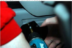
5. Die Mittelkonsole positionieren, auf ca. 5 mm Luft zum Armaturenbrett achten
