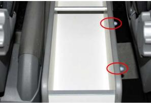
**8.** Die hintere Abdeckung des Sitzkastens wieder aufsetzen. Durch das Halteblech ist dabei ein höherer Kraftaufwand als vorher notwendig. Die Abdeckung kann auf Wunsch an der im rechten Bild markierten roten Linie ausgearbeitet werden
