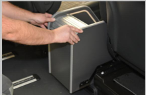
**2** Mittels der beiden Bohrungen im Halteblech zwei Bohrlochpositionen an einen Sitzkasten zeichnen. Dasselbe auf der anderen Seite der Mittelkonsole mit dem anderen Sitzkasten wiederholen.
