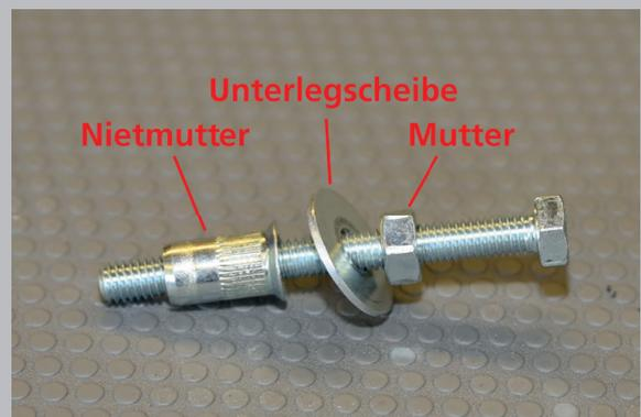
**Hinweis:** Zur Simulation der Seitenverkleidung wurde ein Metallwinkel verwendet. Die Nietmuttern müssen in die in Schritt 1 freigelegten Löcher gesetzt werden.
