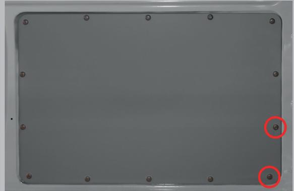
Option A: Nietmuttern mit einer Nietmutternzange nach Herstellervorgaben setzen.
