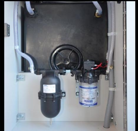
Wassertank, Druckwasserpumpe, Ausgleichsbehälter
