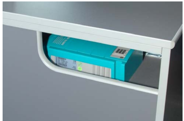
verdeckt montierter Sinus-Wechselrichter mit 300 oder 500 W Leistung
