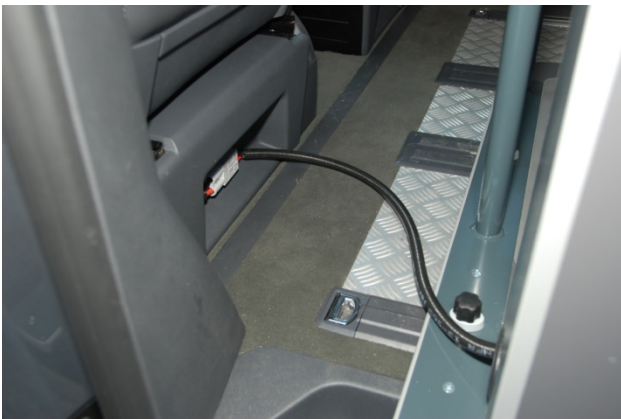
flexible 12 V Stromspeisung von der Fahrzeugbatterie zum Wechselrichter
