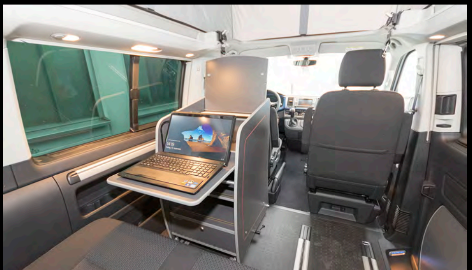
Das Business-Center kann in die linken oder rechten Sitzschienen eingesetzt werden. Das Technikfach ganz unten nimmt Wechselrichter usw. auf. Kanäle führen die Kabel.
