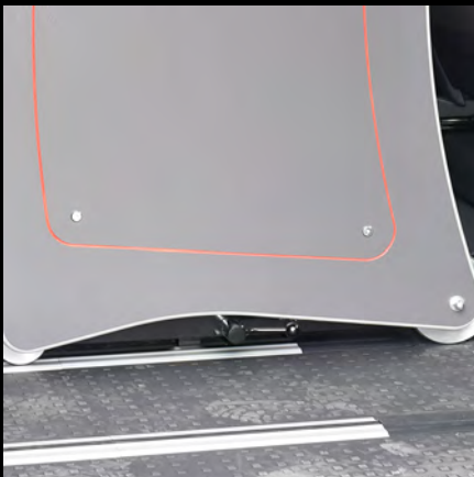
Mit einem simplen Schwenkhebel wird das Business-Center an der Sitzschiene verriegelt
