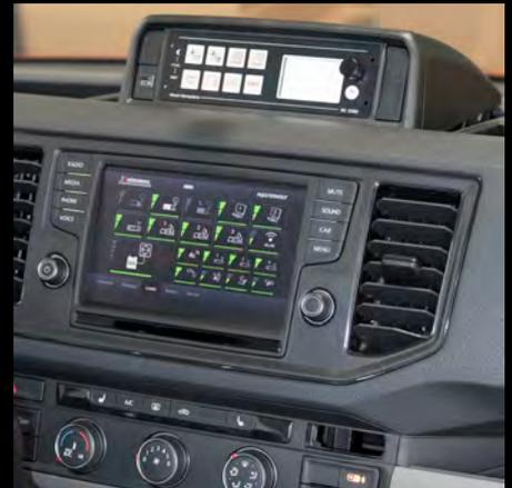
Steuerung und Überwachung des Stromsystems über den Bildschirm der Navigation
