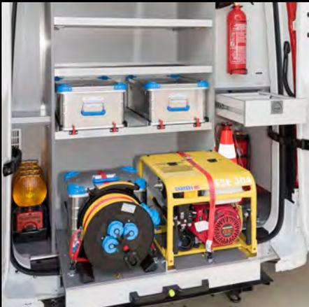
Einrichtung im Heck mit Schwerlastauszug, Euroboxen, Warnleuchten, Pylonenfach usw.
