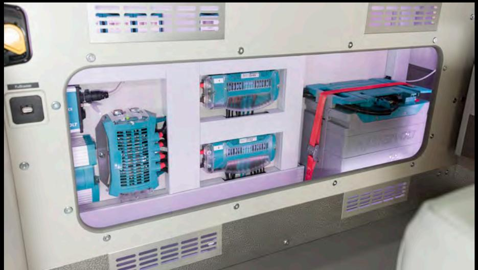
Die Mastervolt®-Stromversorgung mit Lithium-Ionen Batterie, Mass Combi (Ladegerät und Wechselrichter in einem Gehäuse), Ladebooster, sowie Masterbus-Steuerungskomponenten.
