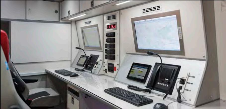
Ergonomische und vernetzte Arbeitsplätze mit Touchscreen-Bediensystem LARDIS® inkl. Sprechstellen. Zwei PCs mit Führungsunterstützungssoftware und Internetzugang über LTE.
