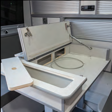
Manuell hydraulisch höhen- und längsverstellbare Arbeitstische.
