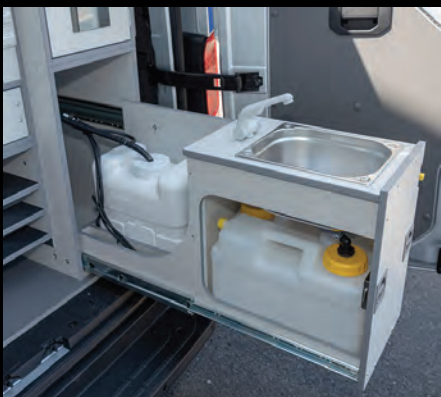
Ausziehbarer Waschplatz mit Frisch- und Grauwasser-Kanister.
