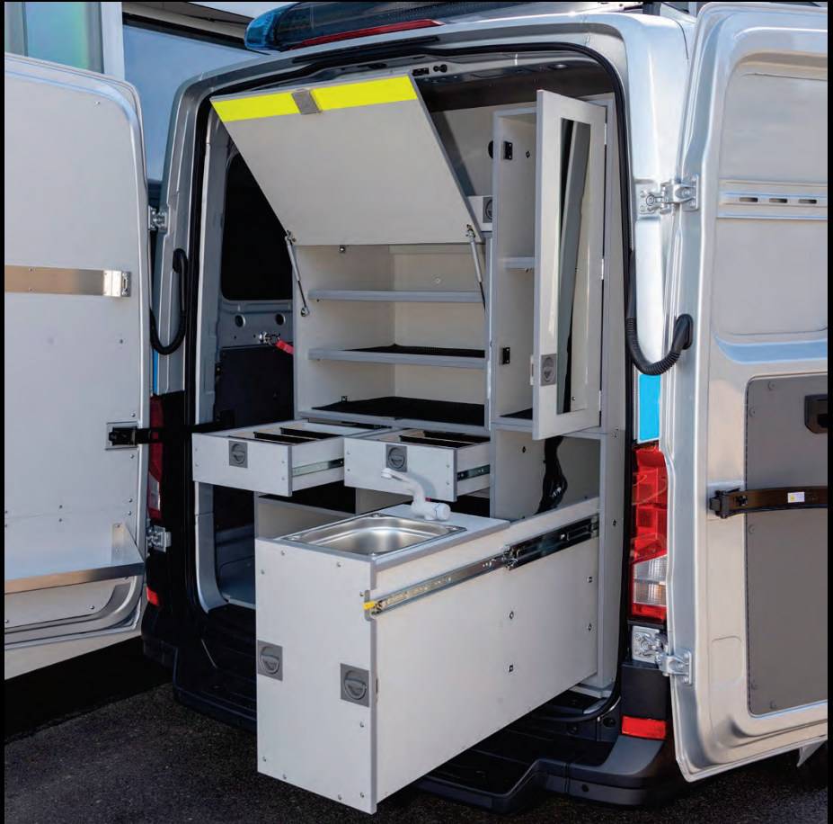
Heckausbau mit div. Fächern nach Kundenvorgabe, Waschplatz, Ladungs-sicherung, Leiterhalter auf der Tür, Steckdosen und Beleuchtung.
