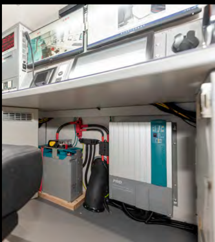
Mastervolt®-System mit Lithiumbatterie und Mass Combi für eine sichere, netzunabhängige Stromversorgung aller Verbraucher.
