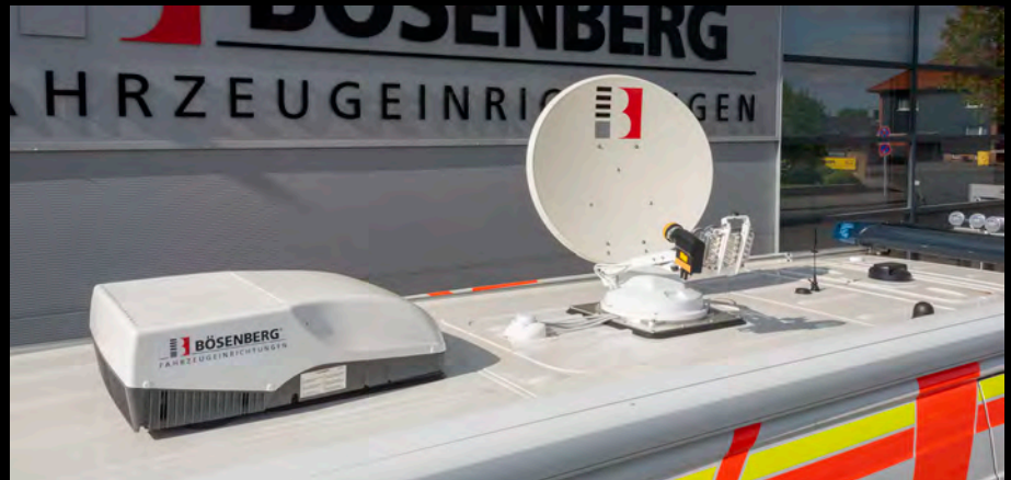
Dachklimaanlage, Satelliten-Empfangeinheit, Antennentechnik und Sondersignalanlagen von Hänisch® auf dem Dach
