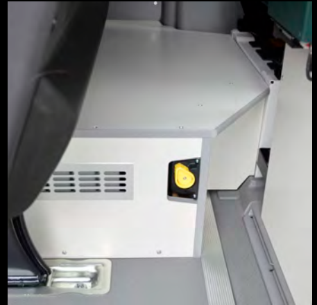
Belüftete Elektrobox mit Hauptschalter, an die Fahrzeugkonturen angepasst
