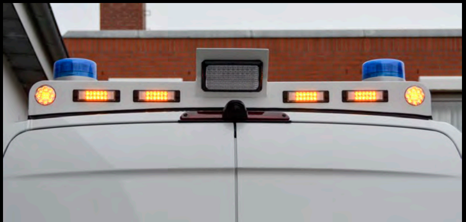
Elblinger-Heckkonsole mit LED-Blinkern, LED-Heckabsicherung, LED-Umfeldbeleuchtung und Rückfahrkamera
