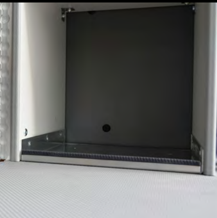
Das Zurr schienensystem ist flächenbündig in den Boden eingelassen und zwischen die Regal-seiten und unter die Deckenverkleidung montiert
