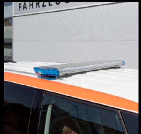
Warnbalken Standby W3. Montage über Datenschiene. Steuerung über Mangora®.
