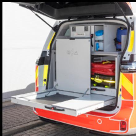
Eine ausziehbare Fläche zur bequemen Bestückung des Fahrzeugs nach dem Einsatz.
