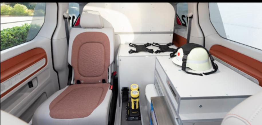
Der großzügige Sitzplatz für den Notarzt. Alle Einsatzmittel und die Hygiene-Komponenten sind leicht erreichbar. Eine ausziehbare Schreibplatte erlaubt Dokumentationsarbeit nach dem Einsatz.
