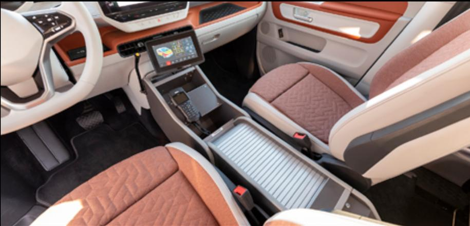
FlowingCenterConsole® - formschön und funktional verbindet diese Konsole Funktion und Ästhetik auf einzigartige Weise. Sie bietet viel Stauraum und zahlreiche Montageflächen für alle Komponenten der Steuerungs- und Kommunikationstechnik.
