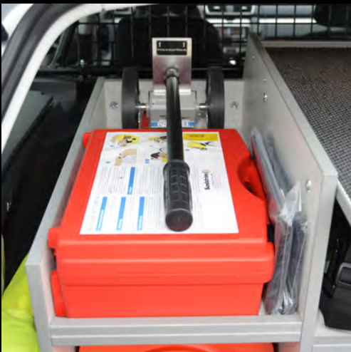
Lagerung von Meßrad und Erste-Hilfe-Kasten
