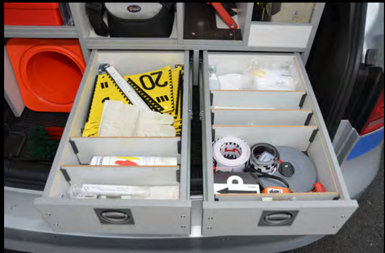
Schubkasteneinteilung mit stufenlos verstellbaren Querteilern
