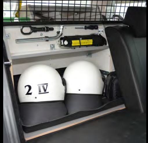
Lagerung der Helme, Zugriff vom Innenraum
