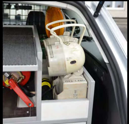
Lagerung von Blitzleuchten und Handscheinwerfer
