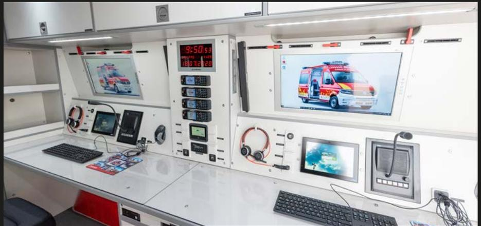
Ausstattung der Arbeitsplätze mit PC und LARDIS®-Funkbesprechungssystem. Funkturm mit GPS-Uhr, vier MRTs und Touchscreen zur Energieüberwachung.
