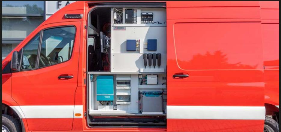
Zuverlässige Energieversorgung dank Mastervolt® Lithium-Ionen-Batterie und Combi. Kommunikationssystem mit LTE-Router, vier MRTs und Antennenkoppler.
