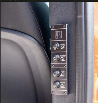
Bedienpanel an der Schiebetür für die Innen- und Außenbeleuchtung.
