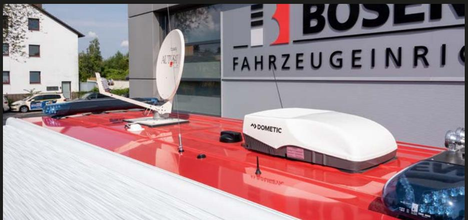
BOS-Satellitenantenne, Sondersignalanlage Hänsch DBS 4000, versch. Antennen sowie Dachklimaanlage auf dem Dach.
