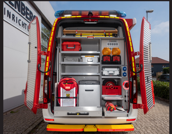
Heckausbau mit Schwerlastauszug, viel Stauraum und zusätzlicher Beleuchtung.
