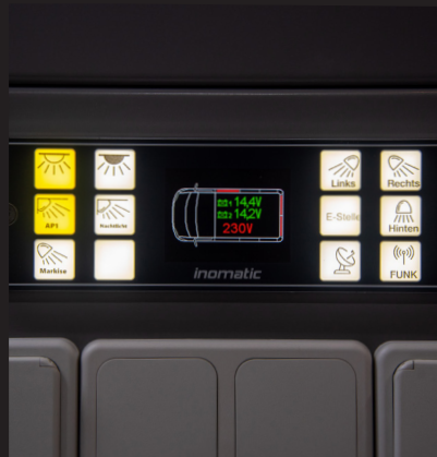
Schaltung aller Funktionen über das Inomatic®-Bussystem.
