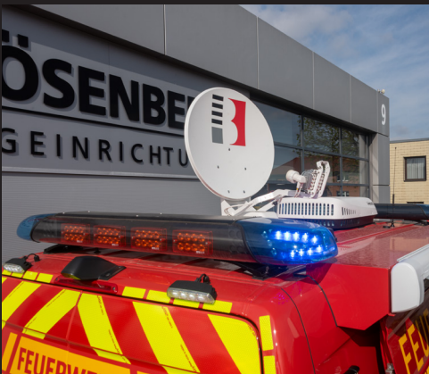
BOS-Satellitenantenne, Sondersignalanlage Hänisch DBS 4000, TETRA-Antenne sowie Dachklimaanlage auf dem Dach.
