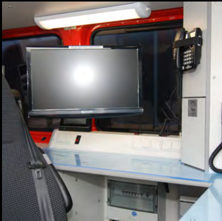
Dreh- und schwenkbarer 24" Touchscreen-Monitor, Anschlüsse für Tastatur und Maus
