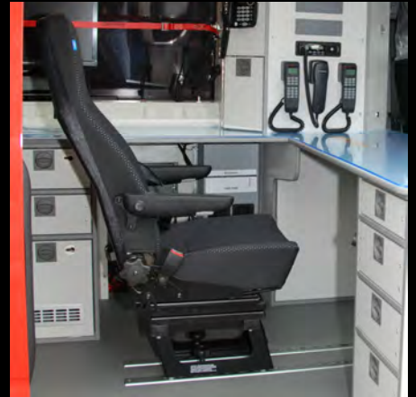
Vielfach verstell- und drehbarer Einzelsitz mit Armlehnen, als Fahrsitz zugelassen
