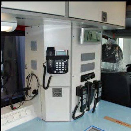
Funkkonsole mit 4 und 2 m Funk und Tetra-Vorbereitung, Telefonanlage
