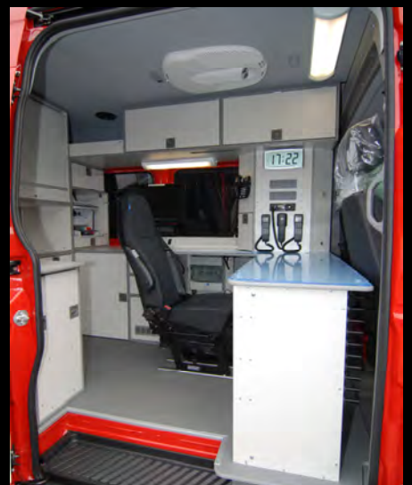
Trennung von Funk- und Besprechungsraum mit Ordnerschränken und Durchgäbe
