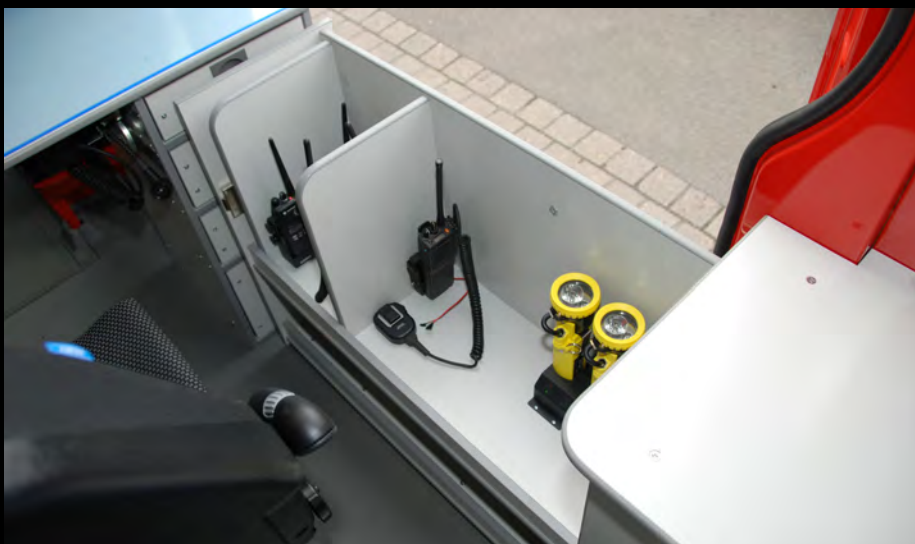
Auszug mit integrierten Stromanschlüssen für Handfunkgeräte, Handlampen usw. Der Auszug dient bei Bedarf auch als Zugangssperre zum Fahrzeug
