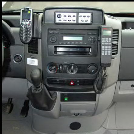
Funkanlage an der Mittelkonsole, Steuerung der Sondersignalanlage in Aufsatzkonsole
