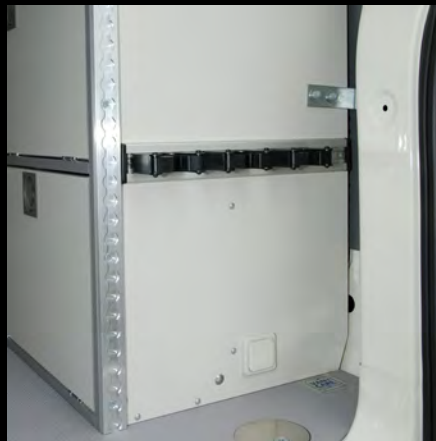
Klemmhalter und Airline-Zurrschiene zur Befestigung von Werkzeug
