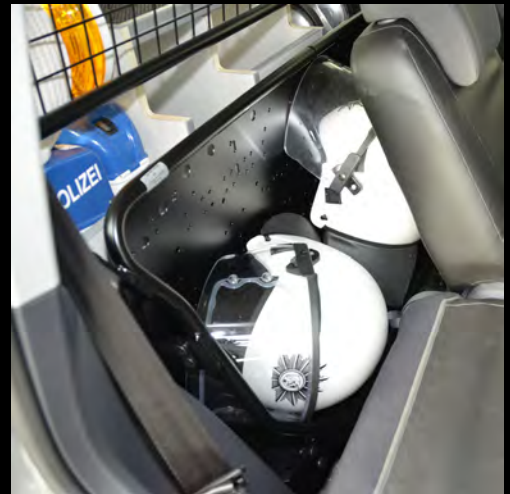
Lagerung der Helme, Zugriff vom Innenraum
