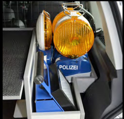
Lagerung von Blitzleuchten und Handscheinwerfer
