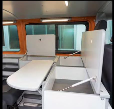
Klappbare Schreibflächen mit Gasdruckdämpfern für Zugriff auf die darunterliegenden Staufächer.
