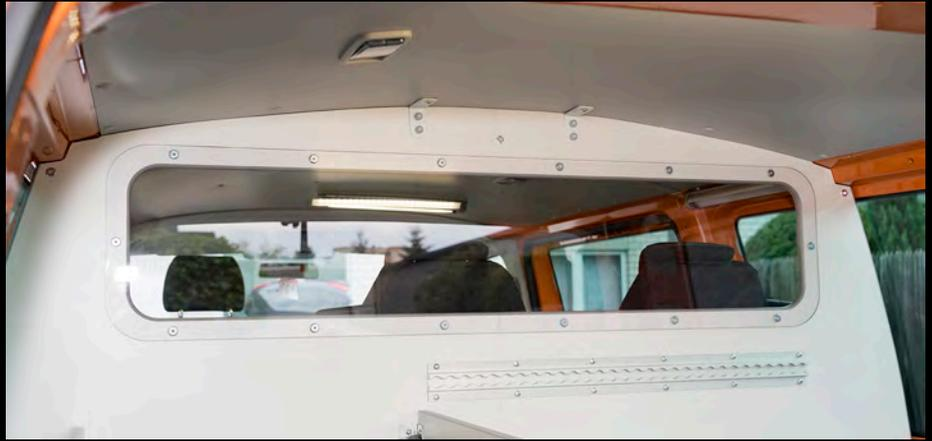
Geschlossene Trennwand mit kratz- und bruchfestem Sichtfenster aus Lexan®. Zurrschienen für die Ladungssicherung.
