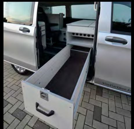
Schwerlastauszug seitlich, darüber eine Rohrhalterung für Prismenstäbe
